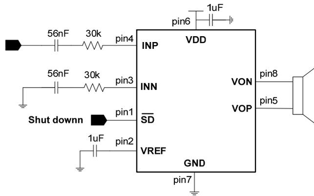
图3. HM2010A 单端输入工作模式电路图
