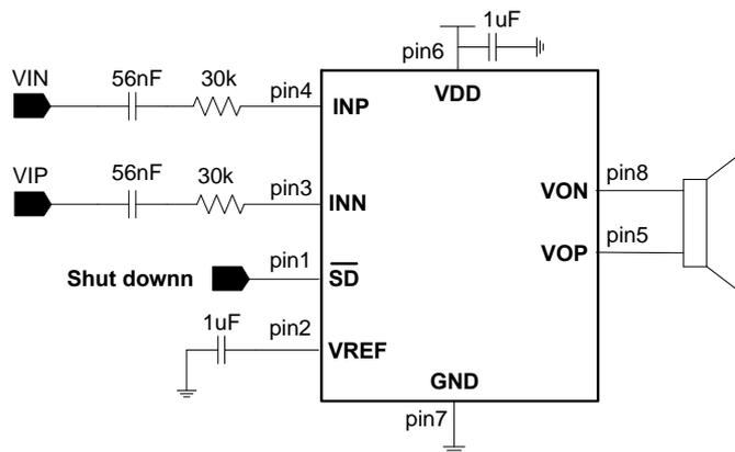
图4. HM2010A 差分输入工作模式电路图
