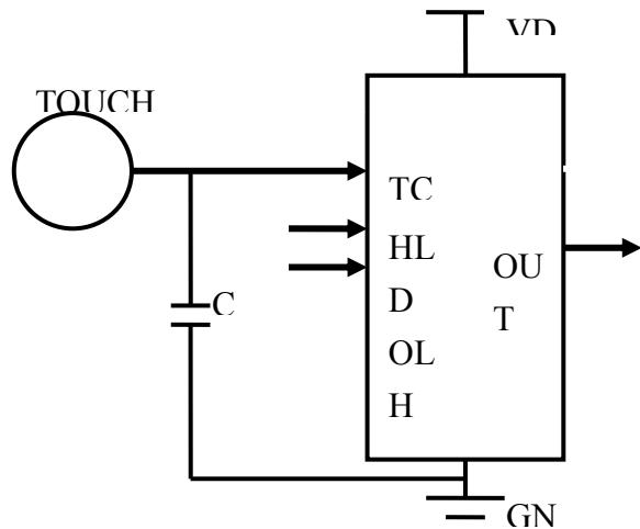
注：1. C<sub>j</sub> 指调节灵敏度的电容，电容值大小 0pF ~ 75pF。电容越小灵敏度越高。
