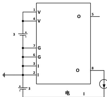
NMOS 体二极管导通电压测试原理图
