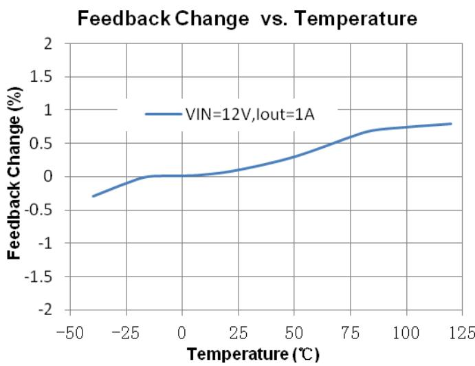
注：内部基准为正温度系数，当输出功率上升导致发热增大结温升高时，反馈电压会升高，起到线损补偿的作用。
