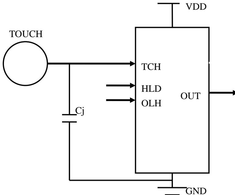
注：1.  $C_j$  指调节灵敏度的电容，电容值大小  $0\text{pF} \sim 75\text{pF}$ 。电容越小灵敏度越高。
