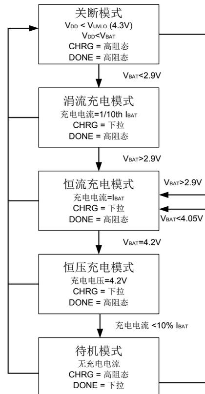
图2 典型充电循环的状态图
