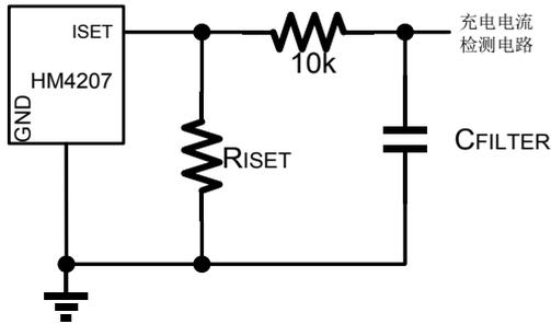
图3 隔离ISET引脚上的容性负载和滤波器
