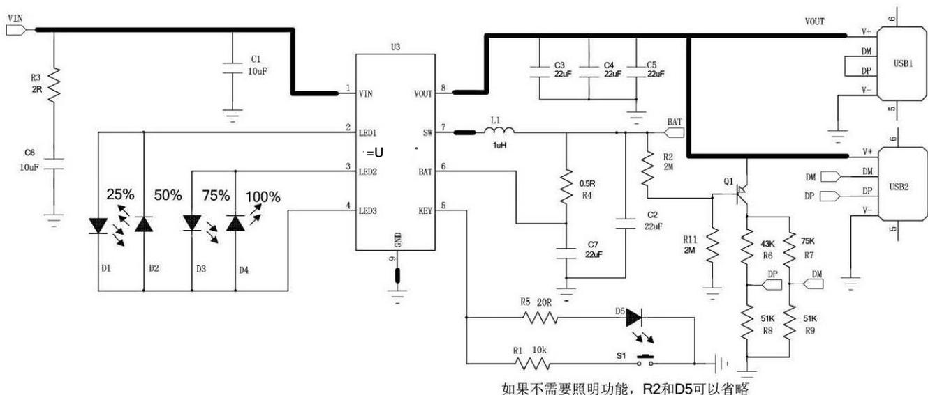
图 7 4LED 电量显示典型应用原理图
