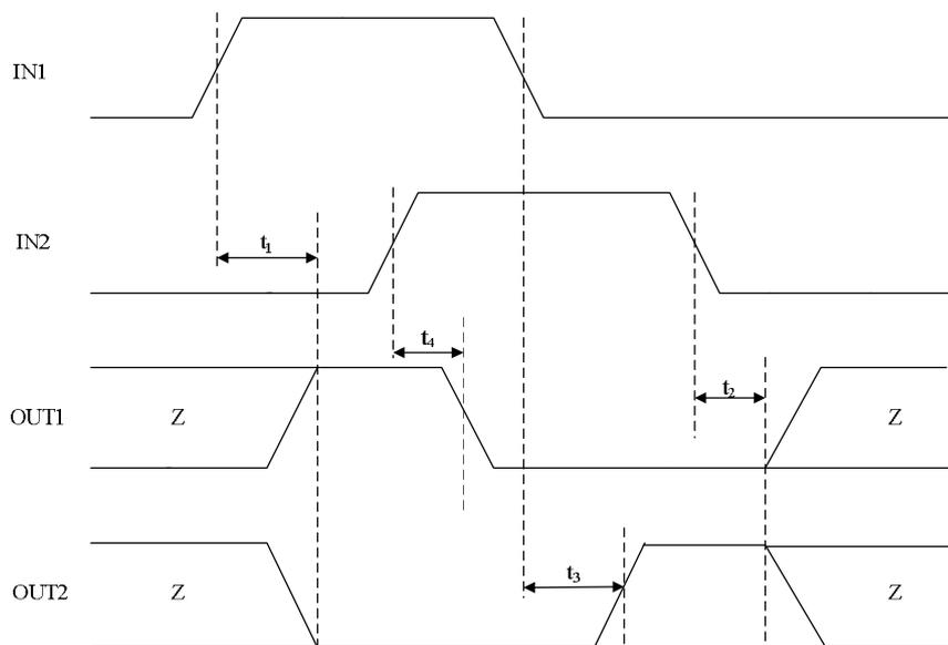
图 2 HM8837 输入输出时间参数 1
