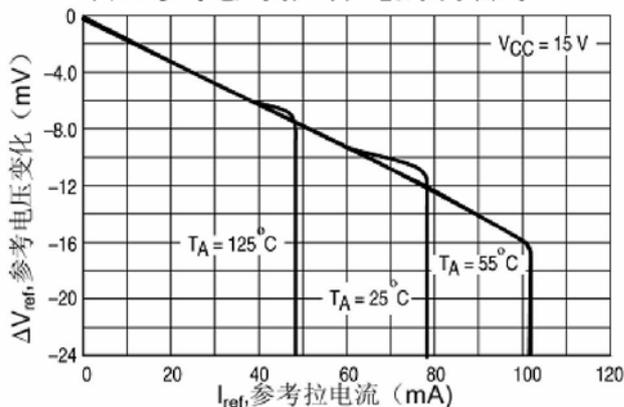
图 10. 参考短路电流与温度关系曲线
