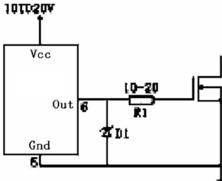
UC3842 脉冲方波能直接驱动场效应管，它具有峰值±1A 的驱动电流。
