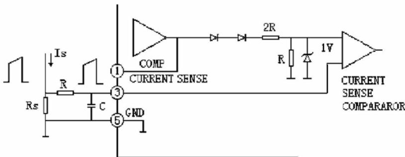
取样电压经误差放大器放大后，送至电流传感比较器转换成电流方式控制脉宽。另外，电流传感比较器起着过电流保护作用，最大输出电流  $I_{max} = (N * 1V) / R_s$  N 为变压器初级匝数之比。
