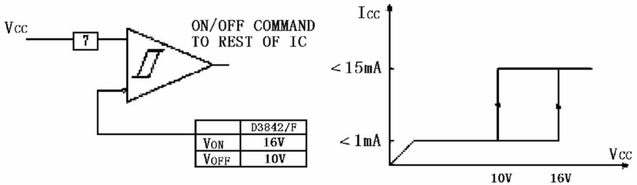
UC3842 内有欠电压锁定电路 (UVL)，启动电压大于 16V，关断电压小于 10V，这样能使开关电源工作稳定，不受电网波动的影响，另外内部采用 5V 能隙基准电源，非常精确和稳定。
