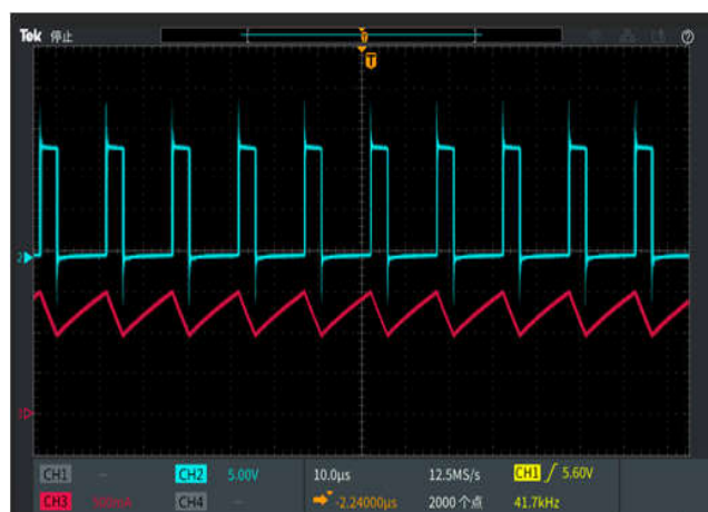
SW 脚与电感电流工作波形
