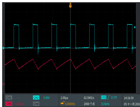
SW 脚与电感电流工作波形
