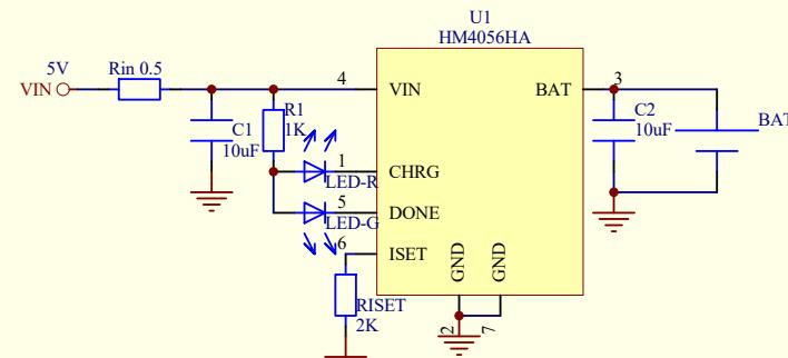
\* $R_{in}$ 用于分担芯片功耗，按 $I^2R_{in}$ 计算，最多允许分掉0.5V
