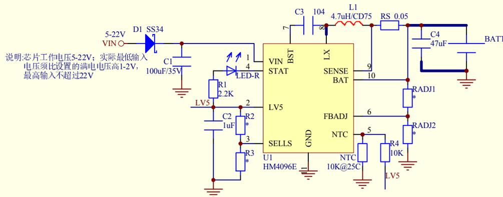
说明:芯片工作电压5-22V; 实际最低输入电压须比设置的满电电压高1-2V, 最高输入不超过22V
